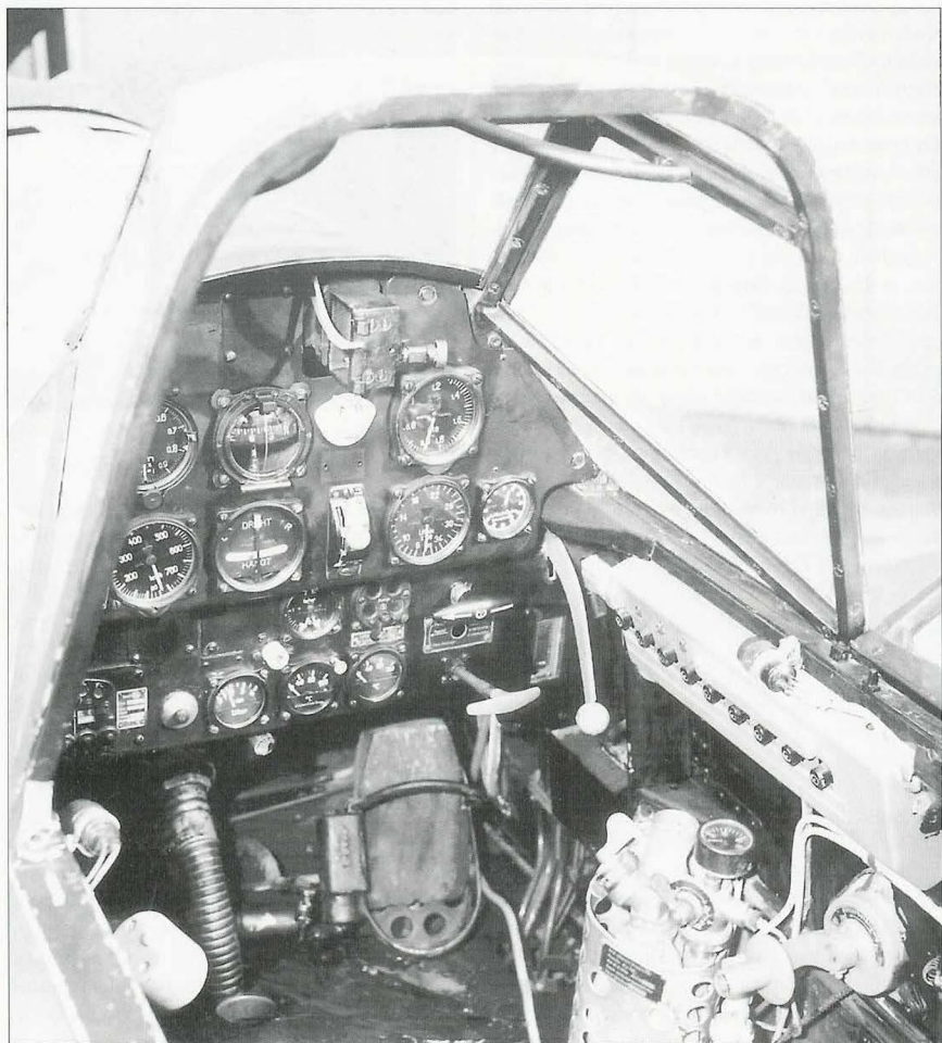
Tablica przyrządów Bf 109E. Zwraca uwagę brak celownika Revi C/12D.
