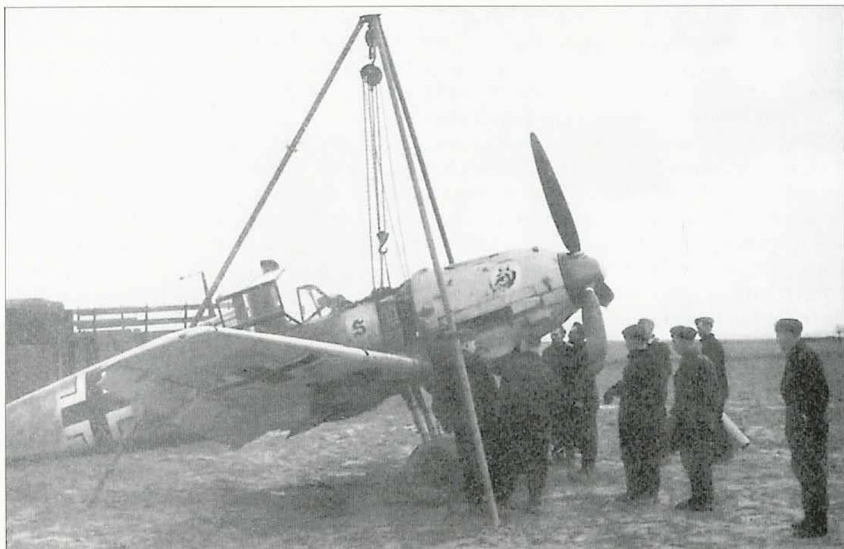
Wcale nierzadki widok podczas bitwy o Anglię. Ten Bf 109E-1 z 2. Staffel lądował przymusowo bez podwozia koło swojego lotniska. Dzięki takiemu prostemu urządzeniu postawiono go na koła i szybko przywrócono do służby.
