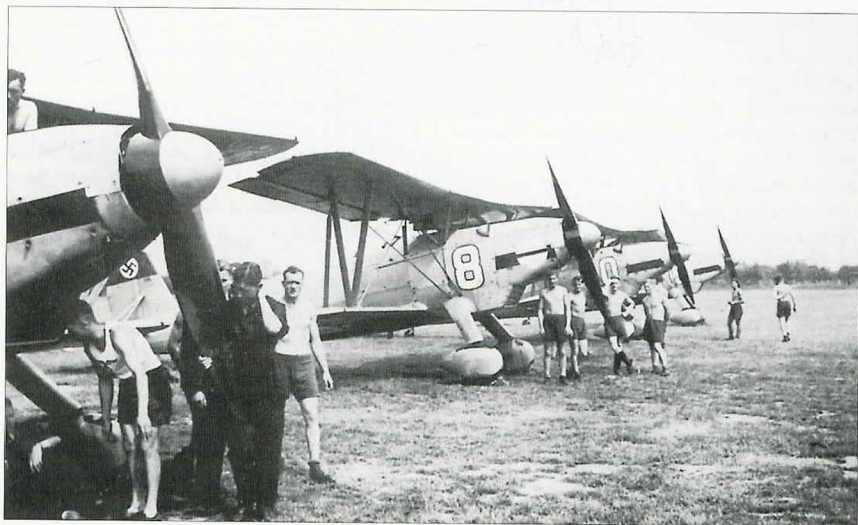
Gdy I./JG 234 latała na He 51, nowo sformowana II./JG 234 została wyposażona w Arado Ar 68E. Ten myśliwiec rozwijał prędkość 310 km/h i okazał się niezwykle użyteczny jako maszyna czasów pokoju.
